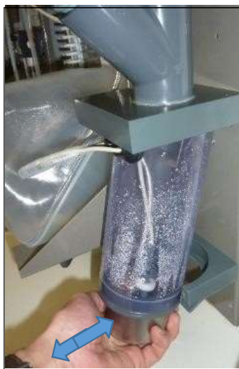
Fig. 34: Wyjmij pojemnik na mgłę
